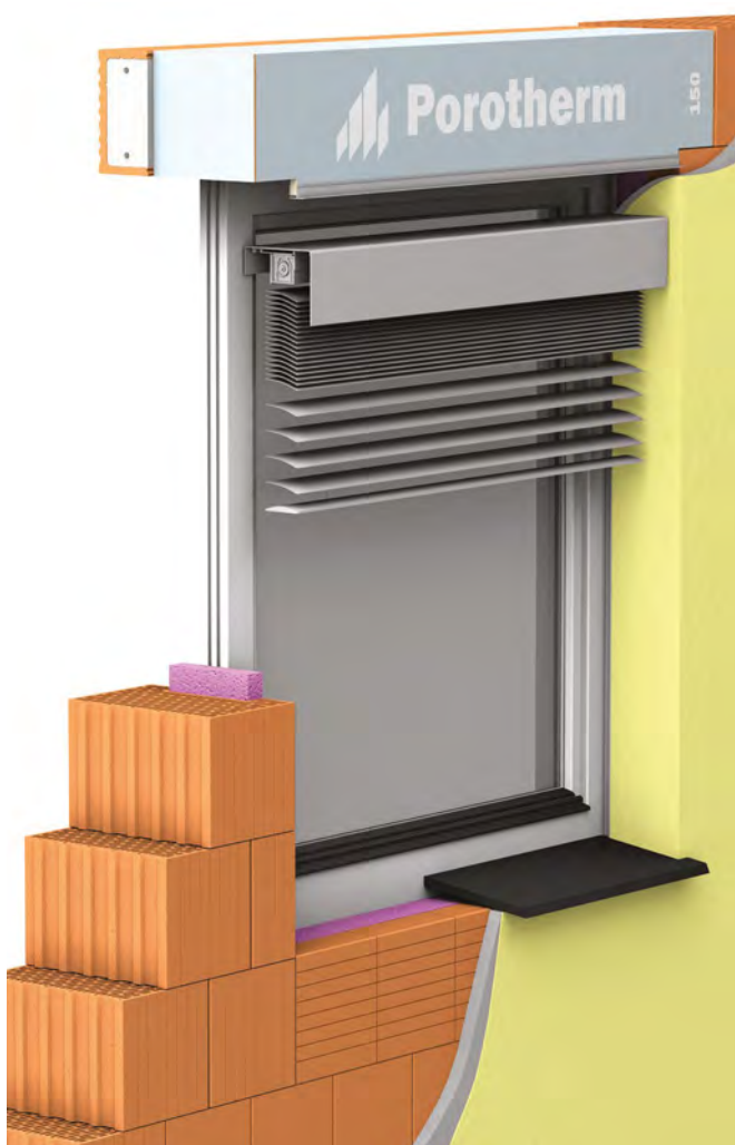
Skladba prekladu Porotherm Vario UNI 100-175 pre rozpätia 750 - 1500 mm
