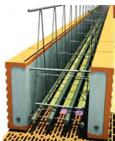
Príklad výstuže prekladu Porotherm KP XL
