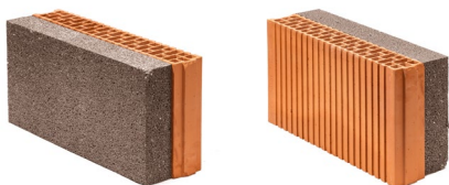
Porotherm VT 24,9 Profi G vencové tehly s grafitovým EPS hrúbka tepelnej izolácie 70 mm
